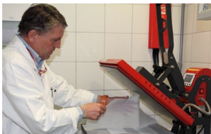
Sichtbarmachung latenter Spuren mit der Transferpresse
